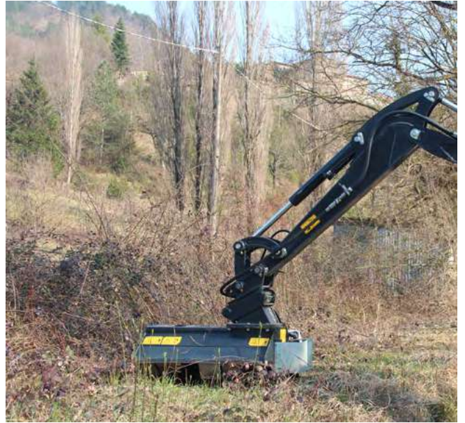
Circuit hydraulique haut débit avec pompe supplémentaire pour utilisation d'un broyeur par exemple.
